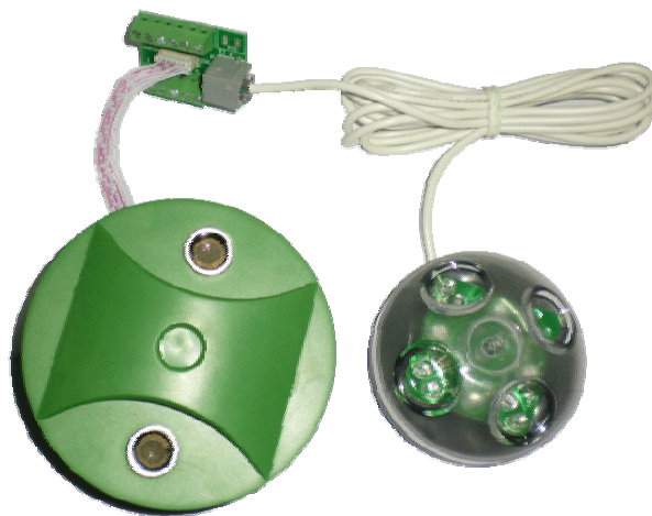
车位探测器外形尺寸：Φ100X48 mm 指示灯外形尺寸：Φ74X35 mm
