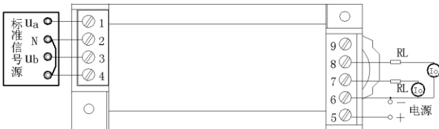
图 6、电流输出产品精度试验接线图
