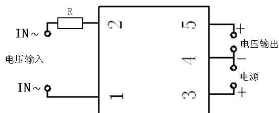
图2、CE-VJ03-32MH1 电压输出产品接线图
