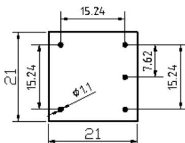
图3、H1 外形安装尺寸图
