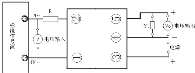
图 4、电压输出产品精度试验接线图
