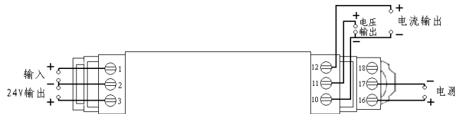
图 2、CE-S#18-#4MD4 一入一出信号隔离器接线参考图
