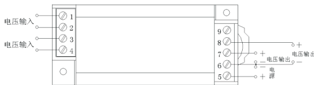
图1、CE-VJ21/21A 直流供电、双相输入、电压输出接线参考图
