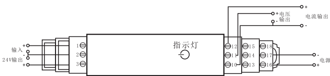
图 1、CE-SU18 一进一出，24V 配电输出，接线参考图
