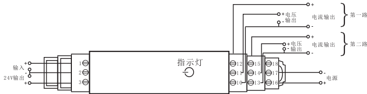
图 9、CE-SZ18 一进二出，24V 配电输出，接线参考图
